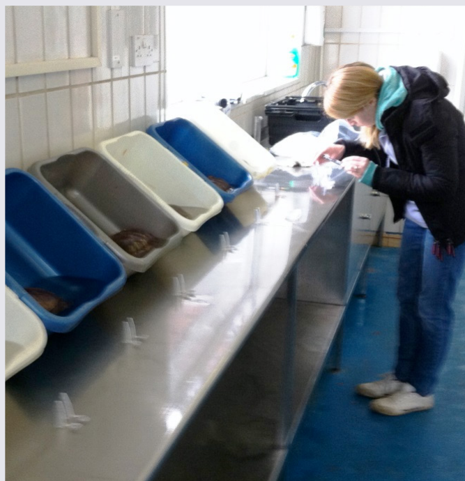
Fig. 5 Recolha de amostras de amónia durante as simulações de transporte em tanques com água; relação 1:1 (sapateiras : água).
