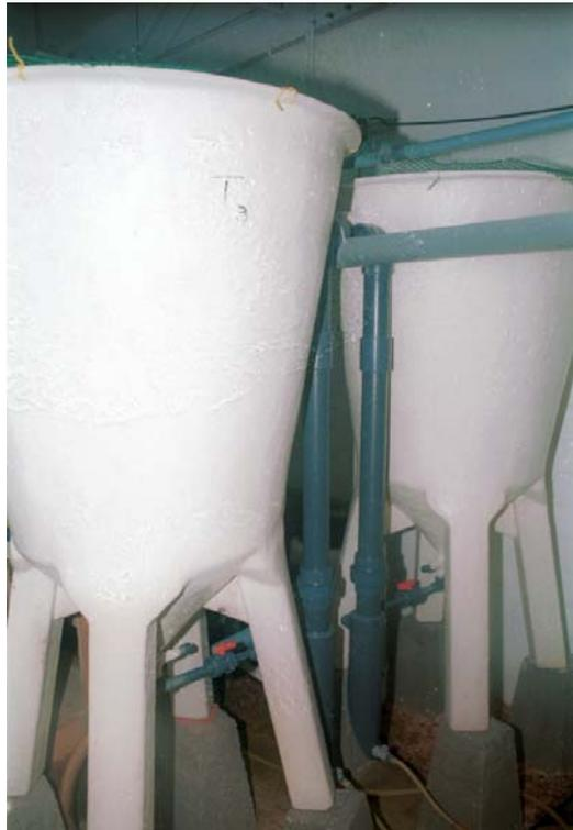
**Figura 2. 2. Tanques do circuito de digestibilidade**
