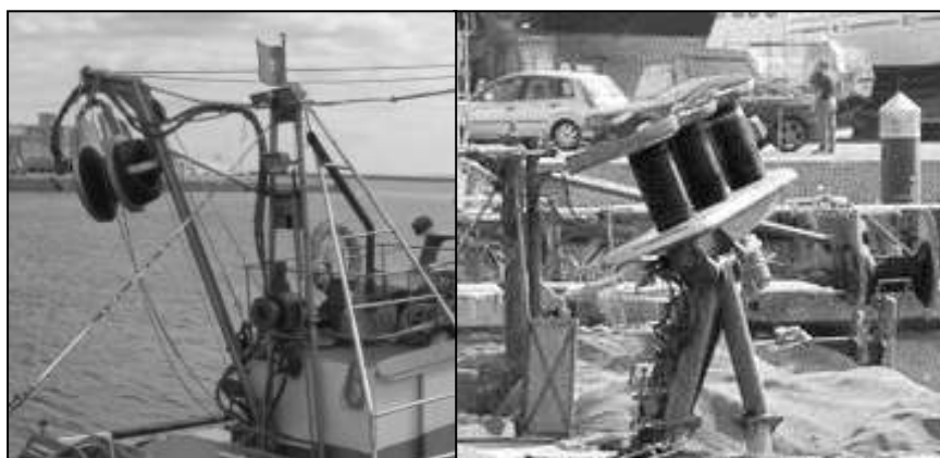
Figura 15 – Tipos de alador para redes de cerco: “power-block” (esq.) e “triplex” (dir.).
