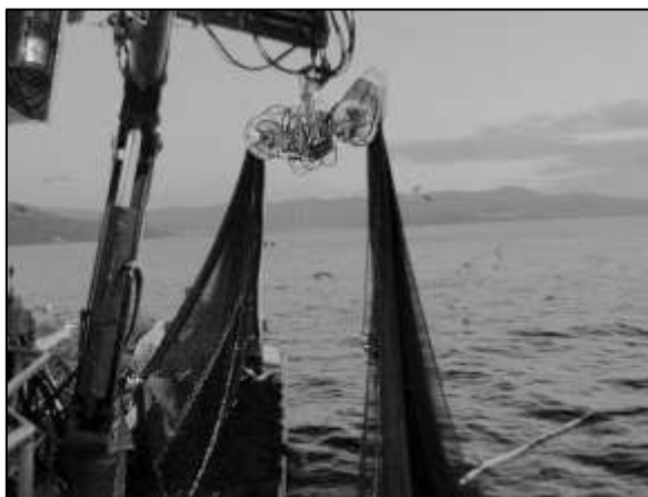
Figura 10 - Alador “triplex” suspenso numa grua hidráulica.
