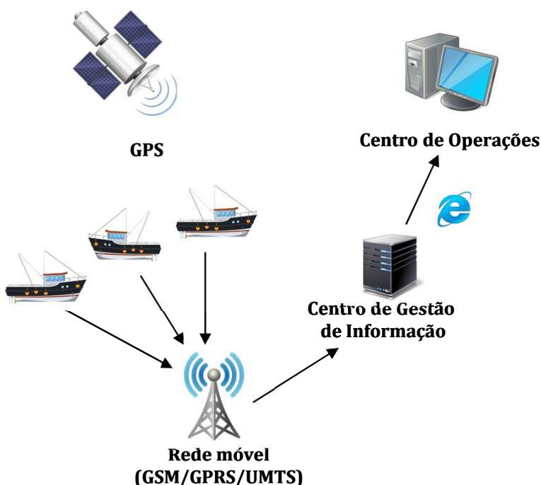
O sistema de seguimento instalado nas embarcações de ganchorra combina as tecnologias de comunicação de última geração, internet e cartografia digital, criando um potente sistema de localização de embarcações.
