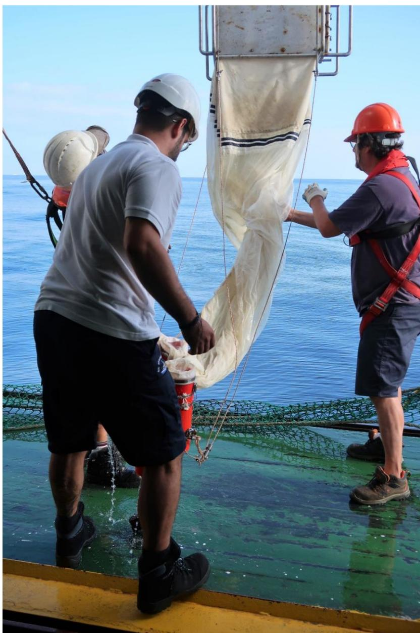
Fig. 4: Recolha da *Multinet* após ter colhido plâncton num perfil vertical em 5 níveis desde os 700 m de profundidade na coluna de água.
