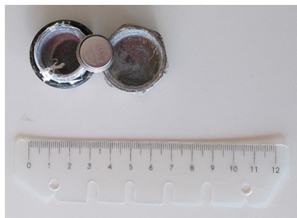
Figura 15- Dataloggers de temperatura para o registo contínuo da temperatura.
