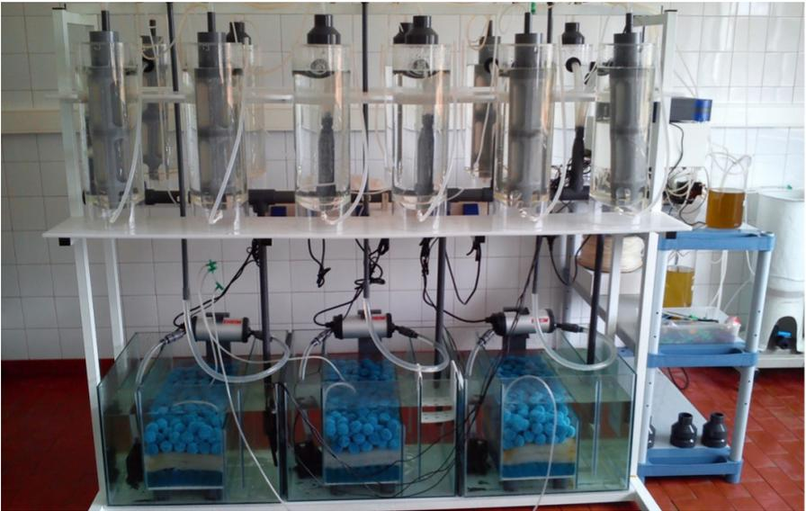
Figura 13 – Sistema experimental de recirculação aquícola para a cultura de larvas de bivalves.
